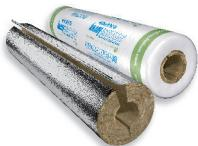
Die Knauf Steinwolle-Rohrschalen Thermo-teK PS ECO ALU sind gewickelte und geschliffene Rohrschalen aus Steinwolle. Das Produkt ist mit einer glasfaserverstärkten Aluminiumkaschierung ummantelt und ist längsseitig mit einem Selbstklebeverschluss ausgerüstet.
